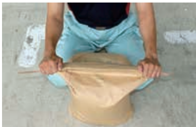
③手前(検査証明欄のある方)から前に向かって、押さえながら袋の口を折り目に沿って、前に一回折った後、もう一回折る。
